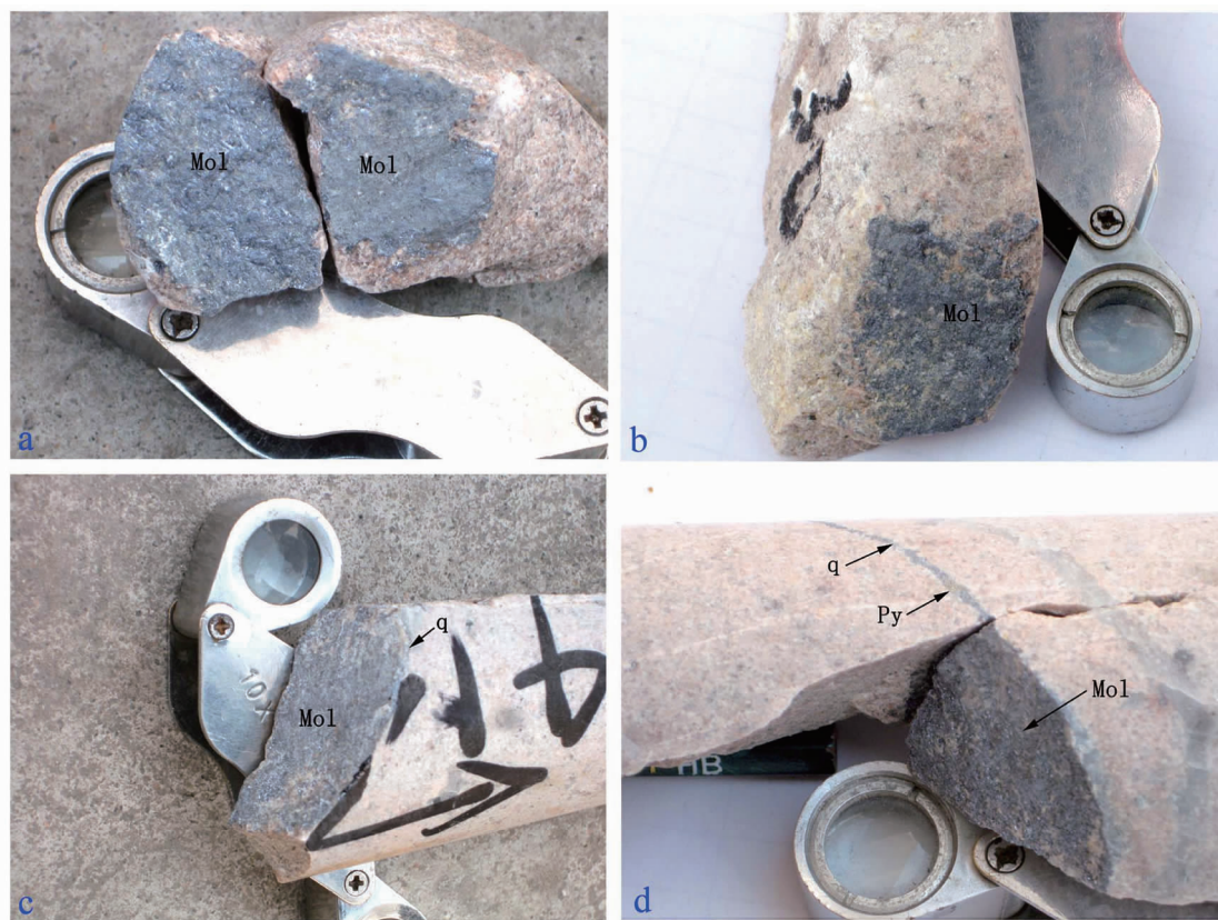
图 4 验证钻孔 ZK1、ZK2 中辉钼矿薄膜(饼)及含矿石英脉
