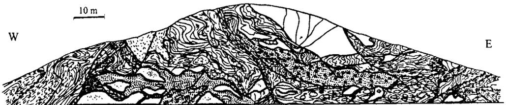
图 5 贝奥沃维路基工程揭露的地质素描图
