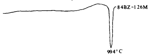
图2 高铁—蓝透闪石的差热分析曲线
