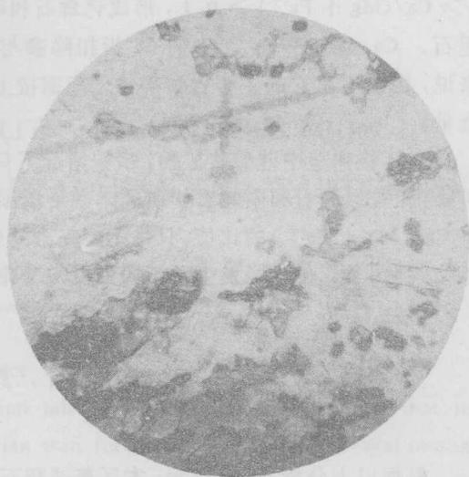
照片 2. 普通辉阳起磁铁矿石英岩。普通辉石(深灰色、不规则柱状)与阳起石(灰色、柱状)的接触界线清楚。
